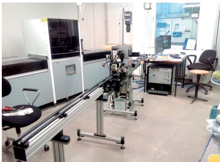
Приборное оборудование лаборатории Университета Кёльна ( ItraxCorescanner – слева на заднем плане, Multi-SensorCoreLogger – на переднем плане). Фото автора
