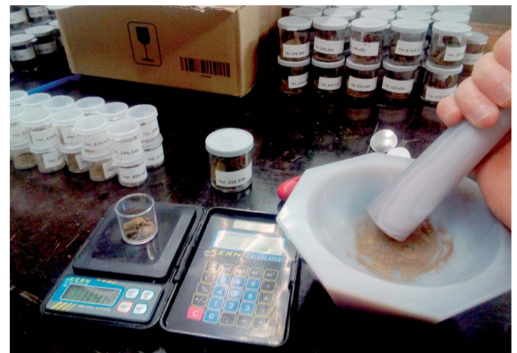
Пробоподготовка для измерения содержания общего углерода: измельчение образцов в ступке. Фото автора
